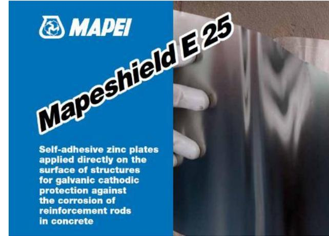
Compuesto por una placa de zinc puro al 99,9% de 250  $\mu\text{m}$  de espesor, acoplada a un gel adhesivo que también es un excelente indicador iónico.
